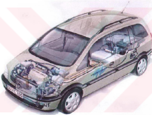
Şekil 8.1 HydroGen 1 yakıt pilli taşıt, 2000 yılında GM ve Opel tarafından geliştirildi [7]
