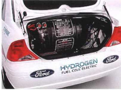
Şekil 8.7 Ford yakıt pilli taşıtının hidrojen deposu [2]
