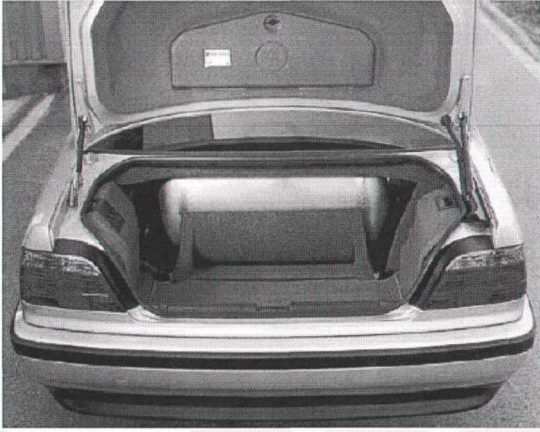
Şekil 5.8 BMW içten yanmalı motorlarda kullanılan hidrojen deposu (Hoogers, 2003)
