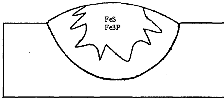
Şekil 3.24 Kaynak metalinin iç kısımlarda FeS ve Fe 3 P oluşumu
