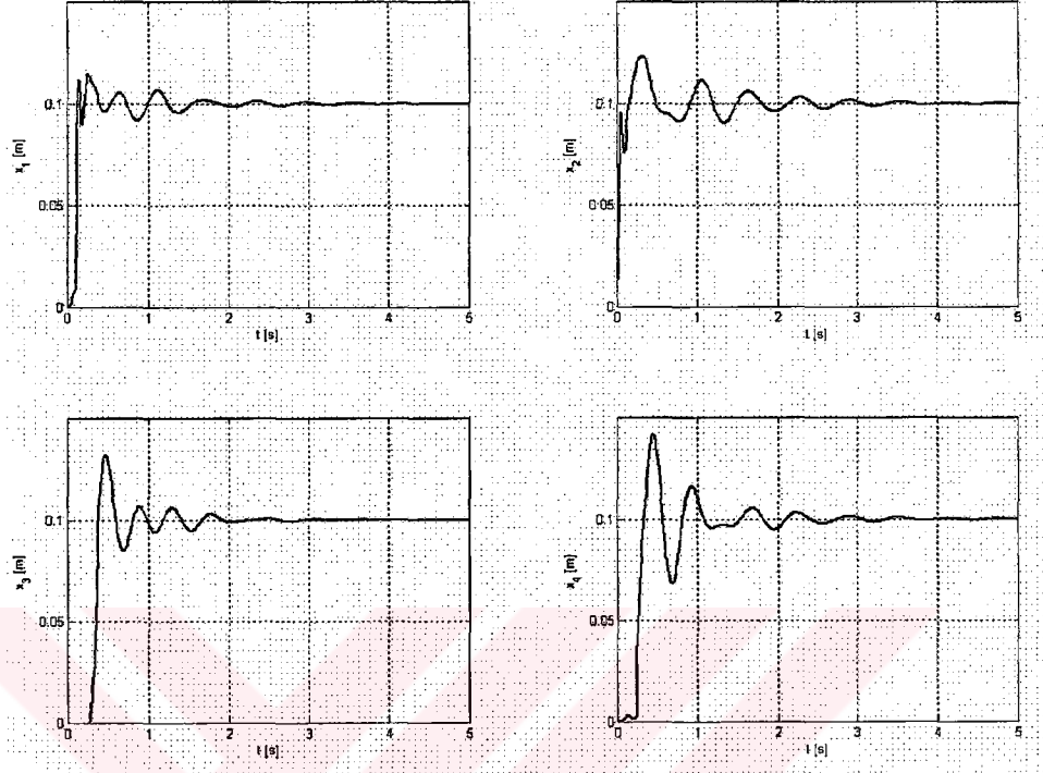
Şekil 3.7 Yedi serbestlik dereceli yüksüz jipin engele çapraz girmesi durumunda aksların yerdeğiştirme zaman cevapları
