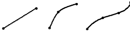
Şekil 4. 1 Meshlemede kullanılan bazı tek boyutlu elemanlar [Ansys,2003]
