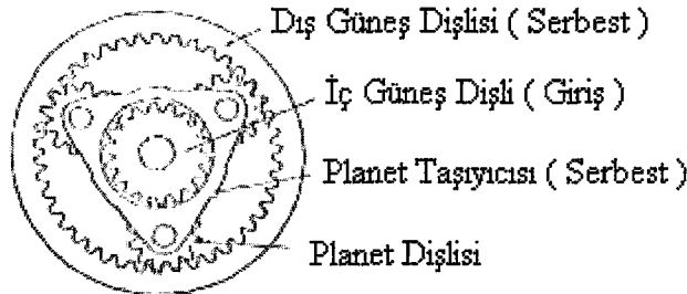
Şekil 2. 9 Planet dişli mekanizmasında 7.durum için hareket iletimi [Erjavec vd.,1992]
