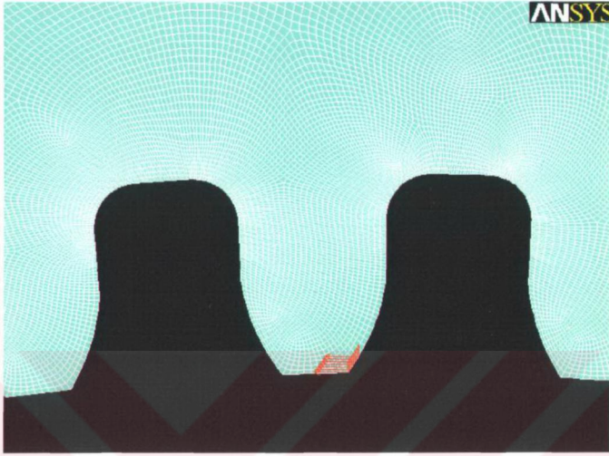
Şekil 5.4 Dış güneş dişlisinin mesh lenip yük leme yapılmış hali
