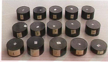
Şekil 5.10 Bakalit içine gömülmüş değişik sürelerde retrogresyon ve retrogresyon ardından yeniden yaşlandırma işlemi görmüş numuneler.
