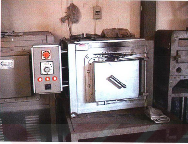
Şekil 5.7 1200°C kapasiteli direnç fırını.
