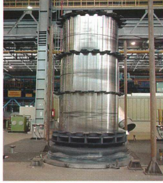
Şekil 3.6 Tav kaidesi üzerinde rulonun görünümü
