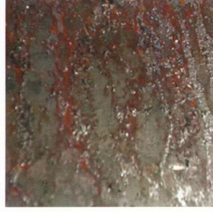
Şekil 7.20 Sırasıyla 60 saat ve 72 saat tuz püskürtme deneyine tabi tutulan siyah sac numuneler
