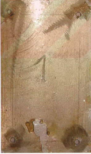
Şekil 7.12 Davlumbaza 3 hafta süreyle asılan, sırasıyla galvaniz ve siyah sac numuneler
