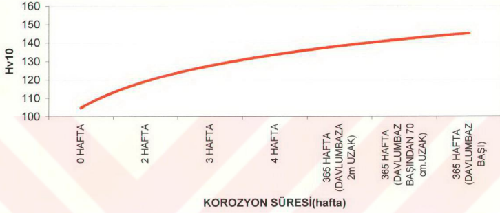
Şekil 8.5 Galvaniz sac numunelerin korozyon süresine bağlı olarak vickers sertlik ölçüm değerlerinin değişimi
