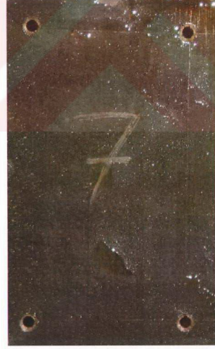
Şekil 7.12 Davlumbaza 3 hafta süreyle asılan, sırasıyla galvaniz ve siyah sac numuneler
