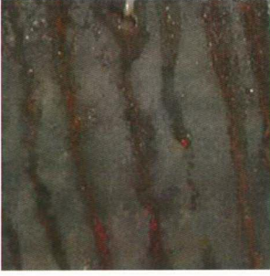
Şekil 7.18 Sırasıyla 12 saat ve 24 saat tuz püskürtme deneyine tabi tutulan siyah sac numuneler
