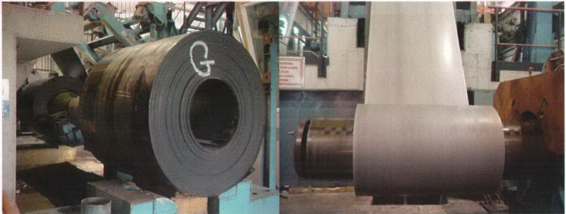
Şekil 3.3 Dekapaj hattının giriş ve çıkışında ruloların görünümü[2]
