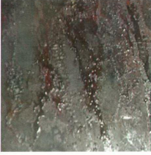
Şekil 7.20 Sırasıyla 60 saat ve 72 saat tuz püskürtme deneyine tabi tutulan siyah sac numuneler
