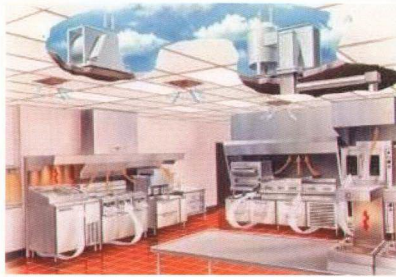
Şekil 2.4 Endüstriyel mutfakta davlumbazdan emilen havanın bacadan atılması[9]
