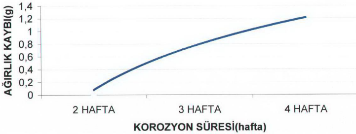
Şekil 8.8 Siyah sac numunelerin korozyon süresine bağlı olarak ağırlık kayıpları
