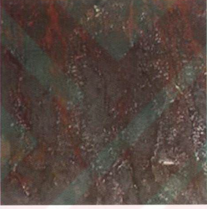
Şekil 7.19 Sırasıyla 36 saat ve 48 saat tuz püskürtme deneyine tabi tutulan siyah sac numuneler
