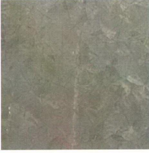
Şekil 7.15 Sırasıyla 12 saat ve 24 saat tuz püskürtme deneyine tabi tutulan galvaniz sac numuneler
