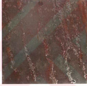
Şekil 7.19 Sırasıyla 36 saat ve 48 saat tuz püskürtme deneyine tabi tutulan siyah sac numuneler
