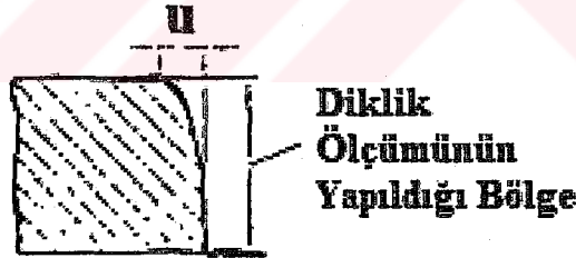
Şekil 3.52 Plazma kesmede diklik ölçümünün yapılması (Anık vd., 1996).
