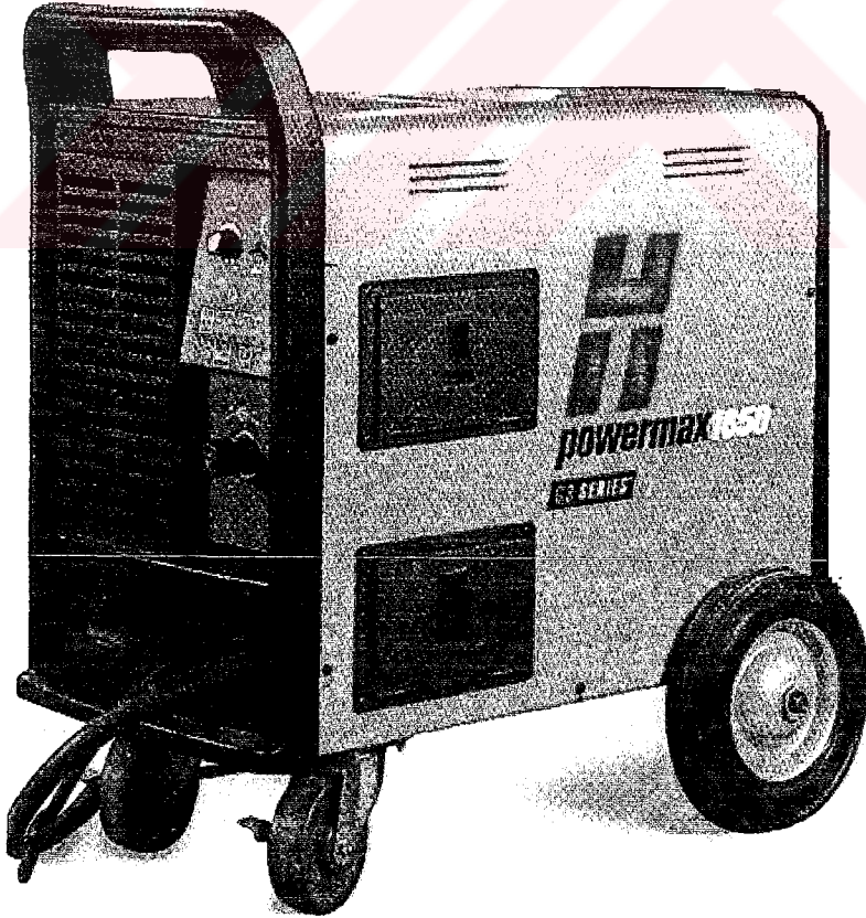
Şekil 3.59 Birinci grup deneysel çalışmanın gerçekleştirildiği akım kaynağı, Hypertherm Powermax 1650
