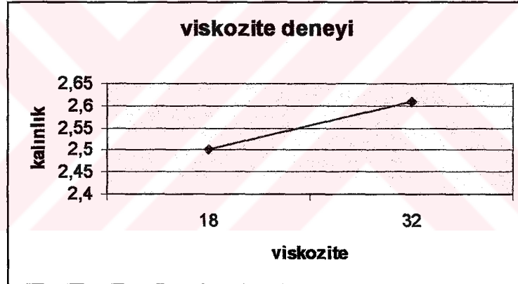
Şekil 8.12 Viskoziteye karşı kalınlık değeri grafiği
