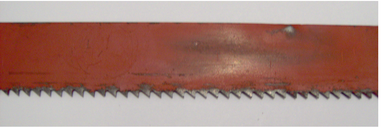
Şekil 4.10 Lama testerede aşınmanın az olduğu yan yüzey.
