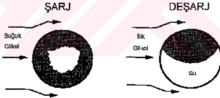
Şekil 5.10 Kapsülle buz depolamada şarj ve deşarj.
