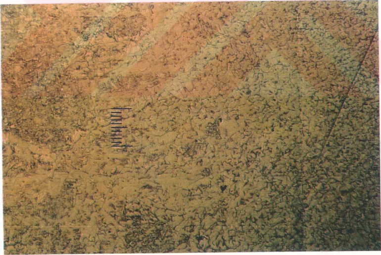
Resim 12.3 “Sol üst” bölgeden alınan 100x büyüklükte görüntü. Ana malzeme ile kaynak dolgu metali arasındaki geçişin homojenliğini göstermektedir.
