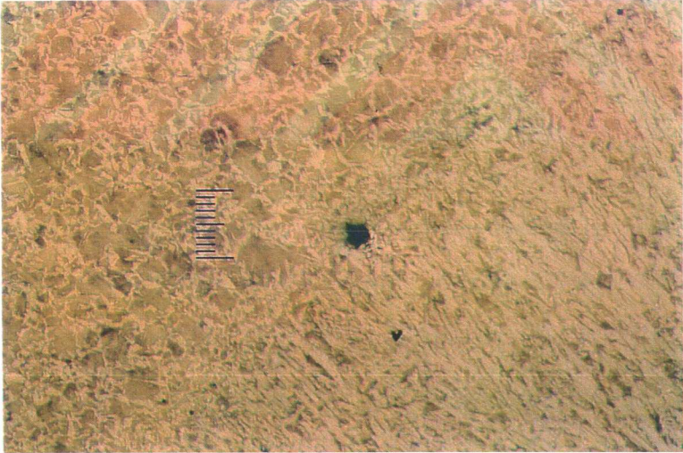
Resim 12.8 “Sağ üst” bölgede boşluk. İki yapı arasındaki geçiş keskin ve belirgin. (100x)
