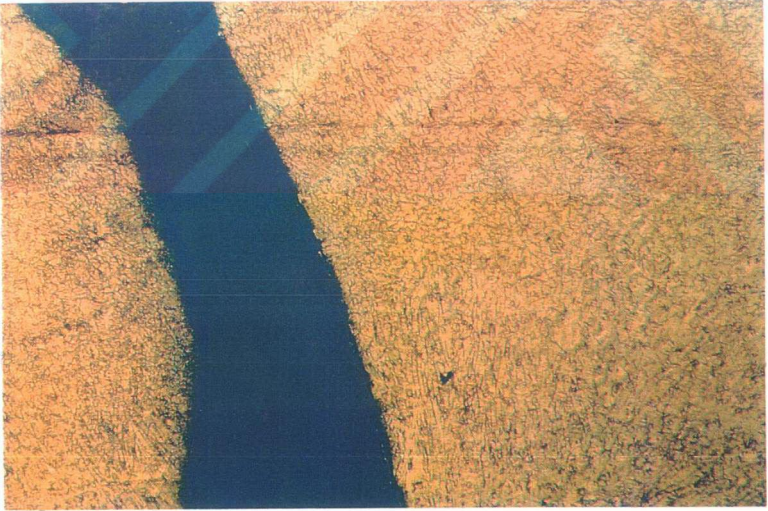
Resim 12.5 Dikişinin ortasından 100x büyüklükte görüntü. Boşluk yok, yapı düzgün.
