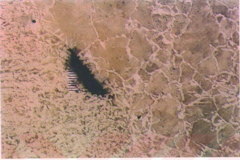
Resim 12.15. Ana malzeme ile dolgu malzemesi arasında boşluk. Yapı geiş belirgin.(100x)
