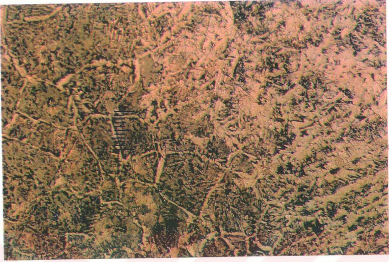
Resim 12.3 “Sol üst” bölgeden alınan 100x büyüklükte görüntü. Ana malzeme ile kaynak dolgu metali arasındaki geçişin homojenliğini göstermektedir.
