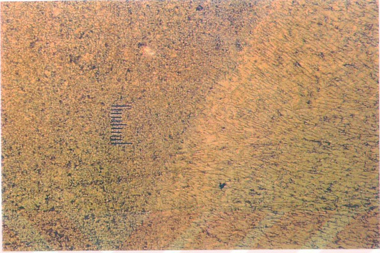
Resim 12.1 Dikişin “ sağ orta” bölgesinden 50x alınan görüntü. Kaynak dolgu metali ile ana malzeme arasında nüfuziyet çok iyi, yapı geçisi çok homojen.
