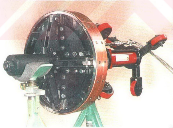
Şekil 11.67 Küçük ve değişik çaptaki borulara kaynak yapmak için kullanılan bir fikstür (Fiksan A.Ş. arşivi, 2000)
