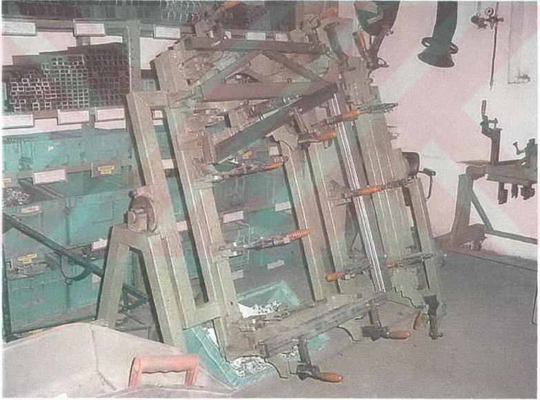
Şekil 11.23 İnsan gücüyle çalışan basit bir karma dönel fikstür (Mercedes Benz Türk A.Ş. fabrikası)
