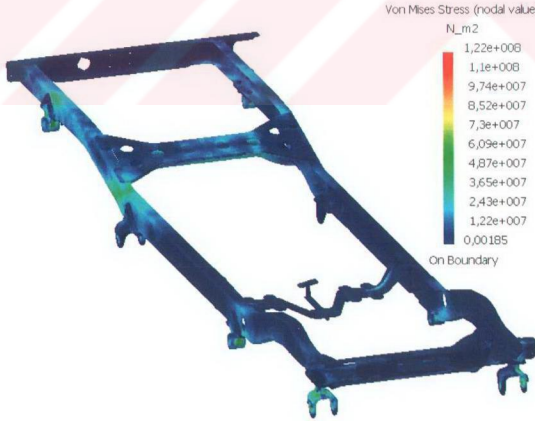
Şekil 3.15 Tek bir arka tekerleğe darbe gelmesi durumunda şasideki gerilmeler
