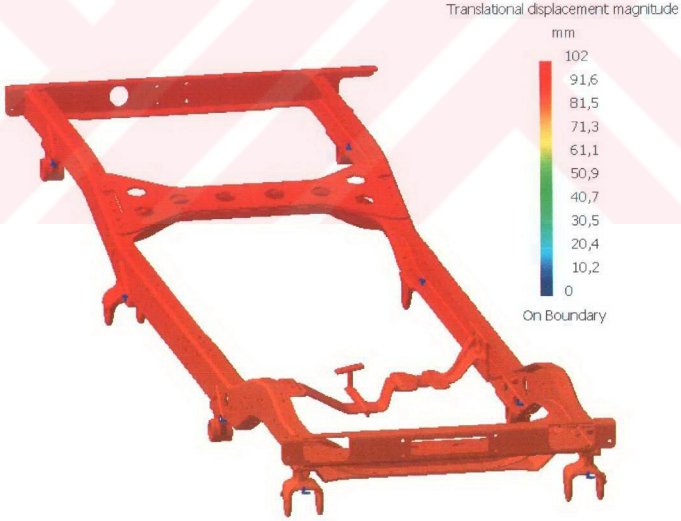
Şekil 3.13 İki ön tekerleğe darbe gelmesi sonucu süspansiyon sisteminin deformasyonu
