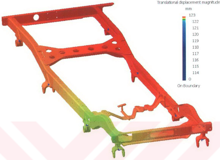
Şekil 3.11 Tek bir ön tekerleğe darbe gelmesi durumunda deformasyonlar
