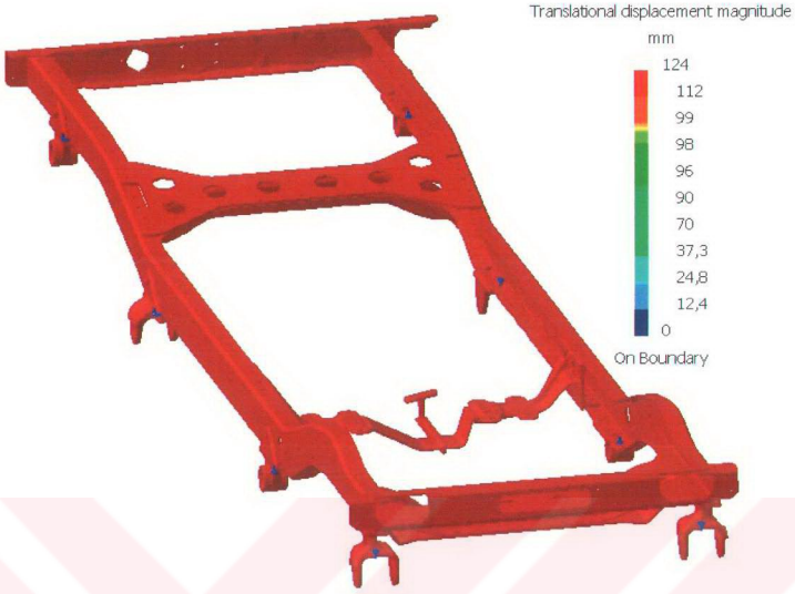
Şekil 3.16 Tek bir arka tekerleğe darbe gelmesi durumunda deformasyonlar
