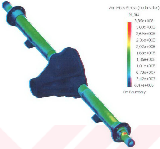
Şekil 5.6 Yan eğimli yolda hızlanma durumunda gerilme dağılımı
