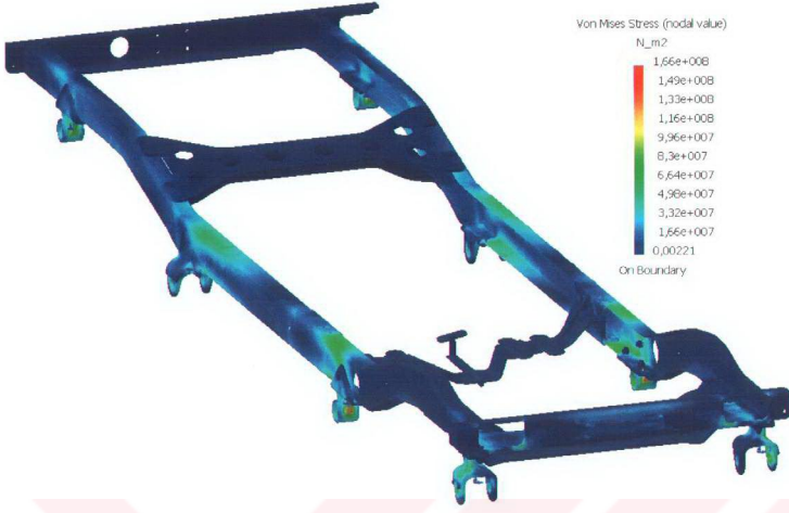
Şekil 3.12 İki ön tekerleğe darbe gelmesi sonucu şasideki gerilme dağılımı
