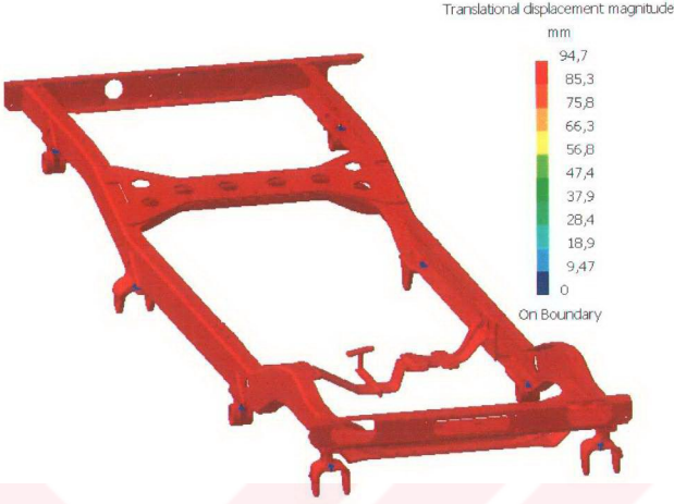
Şekil 3.19 İki arka tekerleğe darbe gelmesi durumunda deformasyonlar
