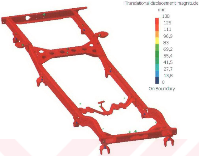
Şekil 3.22 Jeep düz yolda fren yaptığıında süspansiyon sisteminin deformasyonu
