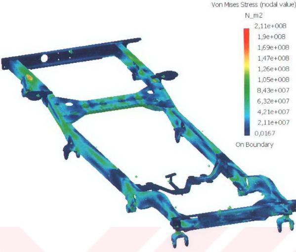
Şekil 3.6 Düşey yükleme sonucu şasi bulunan gerilmeler
