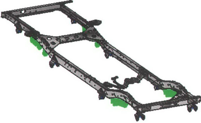
Şekil 3.23 Jeep şasisinin doğal frekanslarını bulmak için kullanılan sonlu eleman modeli
