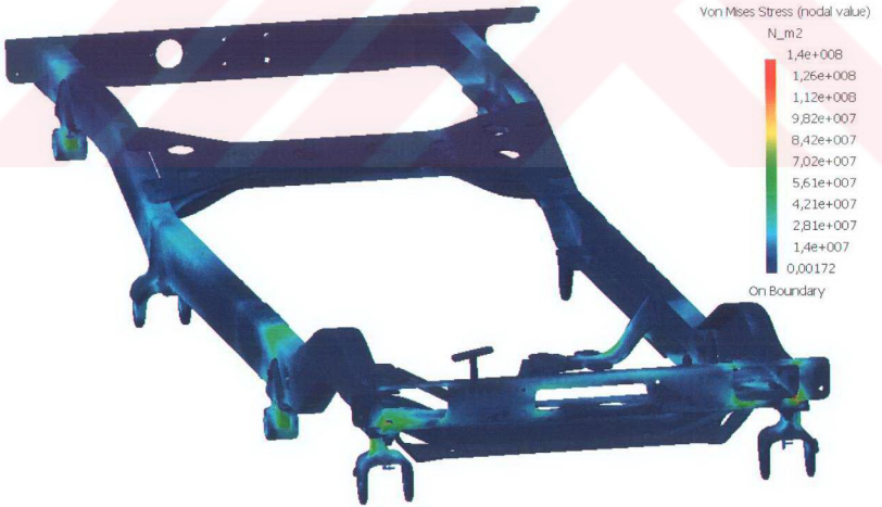
Şekil 3.10 Tek bir ön tekerleğe darbe gelmesi durumunda şasideki gerilmeler
