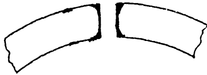
Şekil 4.28 Bant kenarlarında homojen ısı dağılımı
