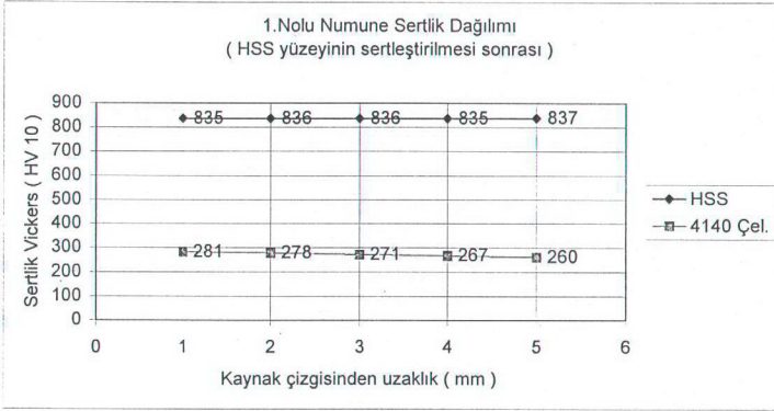
Şekil 6.8 1 No' lu numunenin HSS yüzeyinin sertleştirilmesi sonucu elde edilen sertlik dağılımının grafiksel gösterimi
