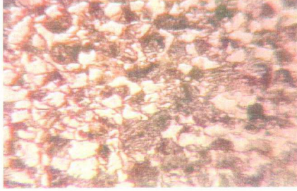
Şekil 7.8 2 numaralı numunenin 4140 çelik tarafının ITAB' ye komşu ana malzemedeki mikroyapısı (x1000)
