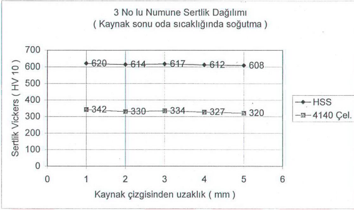
Şekil 6.10 Kaynak sonu oda sıcaklığında soğutulan 3 no' lu numunenin sertlik dağılımının grafiksel gösterimi
