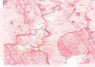
Şekil 4.24 4140 malzeme yüzeyinde yüksek sıcaklıktan dolayı oluşan dekarbürize olmuş kaba taneli yapı (Ferrit, sertlik: 145 HV 10 ) (Makine Takım, 1999)
