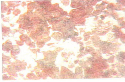
Şekil 7.6 Gerilim giderme ve normalizasyon tavlamlarına tabi tutulan 2 numaralı numunenin kaynak dikişine yakın 4140 çelik tarafının mikro yapısı (x1000)
