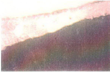
Şekil 7.3.3 numaralı numune kaynak bölgesi mikro yapısı (x250) (kaynak sonrası oda sıcaklığında soğutulan numune)
