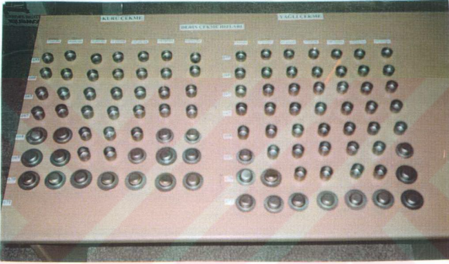
Şekil 7.29 Yağlama ve derin çekme hızına göre başarılı ve başarısız olarak gerçekleşen derin çekme işlemleri
