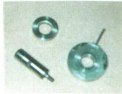
Şekil 7.27 Derin çekme deneylerinde kullanılan düz tabanlı stampa, kalıp ve bastırıcı
