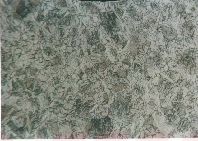
Şekil 5.74. ES Kaynağı K+K1 Geçiş Bölgesi
