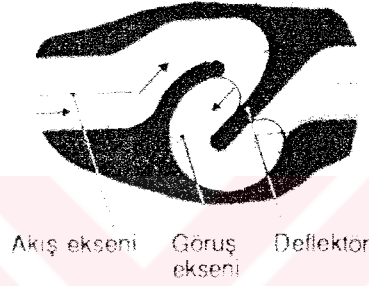
Şekil 5.4.2.2.a Vaposkop sisteminin şematik gösterilişi
