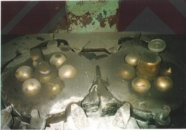
Şekil 3 . 9 – Bilya/Silpebs hattında tablaya bağlı 90°lık bilya kalıpları.
