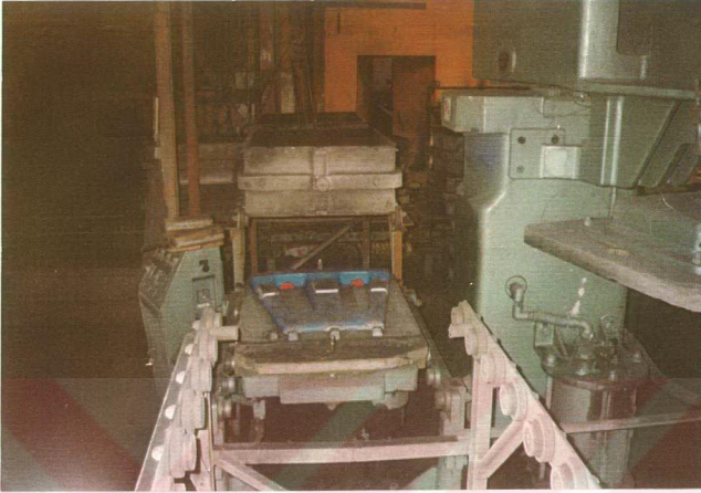
Şekil 3 . 6 – BMM Hattındaki Kalıplamaya Hazır Sarsmalı ZIMMERMANN presi
