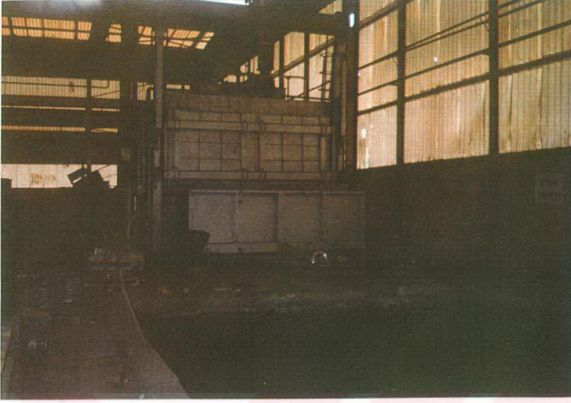
Şekil 3 . 14 – 6600x4600x3080 mm. boyutlarında suda soğutma sistemine sahip fırın
