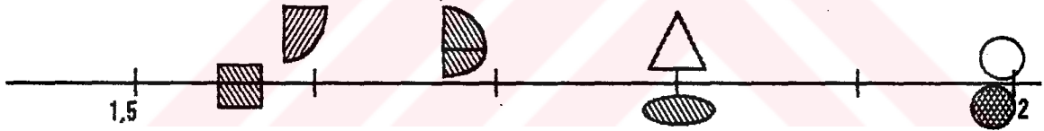
Şekil 34 . 37Cr4 çeliği için çevresel kanal şeklindeki çentik geometrisi ve çekme durumu için çeşitli K_C önerilerinin deneysel K_C değerine yakınlıkları ( K_C = 1,57 , K_t = 2,16 )
