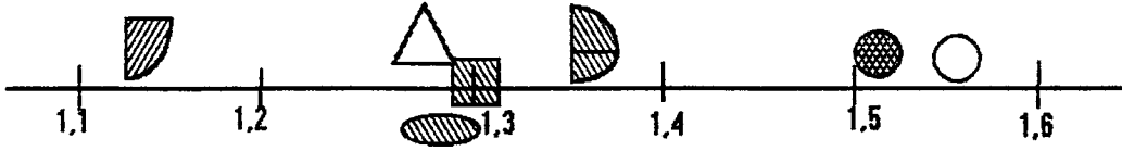
Şekil 52. Fe 38 malzeme için enine delik şeklindeki çentik geometrisi ve eğme durumu için çeşitli K_{\text{ç}} önerilerinin deneysel K_{\text{ç}} değerine yakınlıkları ( K_t = 1,63 )
