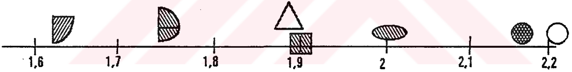
Şekil 58. Fe 50 çeliğinde, enine delik şeklindeki çentik geometrisi ve çeki durumu için çeşitli K_{\text{Ç}} önerilerinin deneysel K_{\text{Ç}} değerine yakınlıkları ( K_t = 2,48 )
