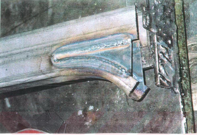
RESİM 13.10. Alt montaj grubuna ayrılarak kaynak edilmiş boyuna taşıyıcı
