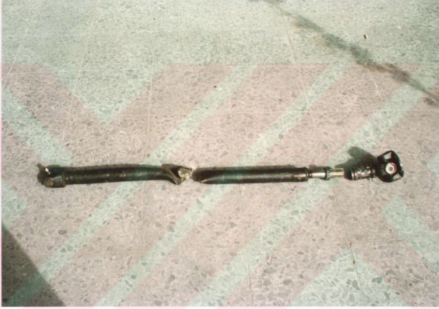
Resim 2.1.4- Trans yataksız kardan mili kırılmış hâli
