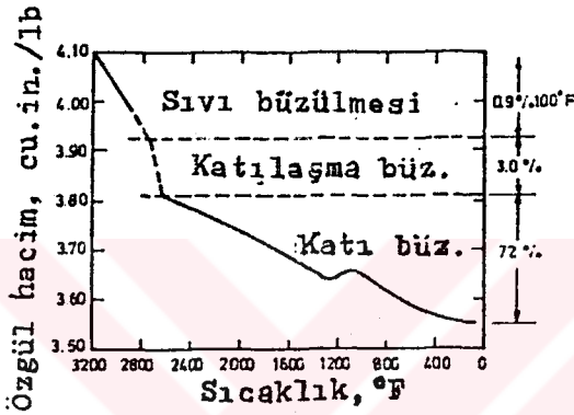
Şekil 1.10.1. Soğuyan ve katılaşan özgül çelik hacminin değişimi. (8)
