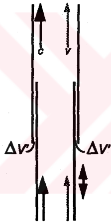
Şekil 4.12 Pnömatik bir vakum tesisinde teleskobik boru montajı
