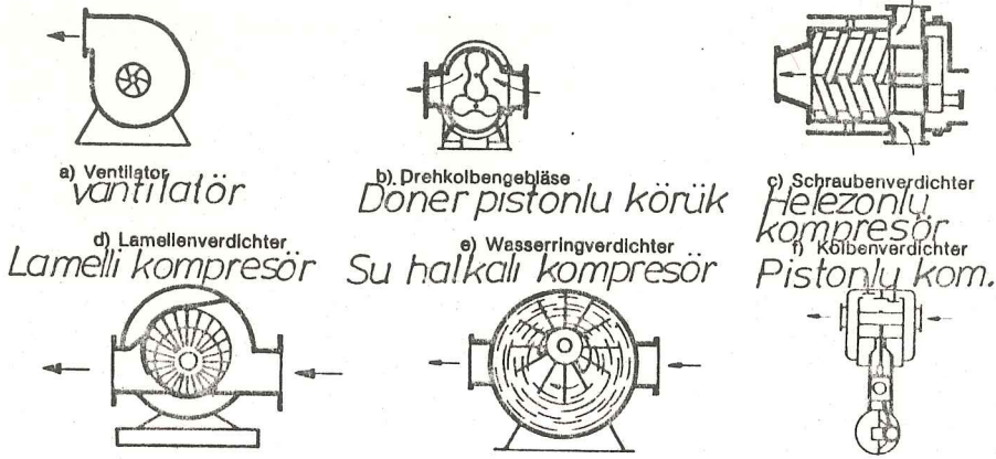
Resim 25-Pnömatik transport için körük ve kompresör tipleri
