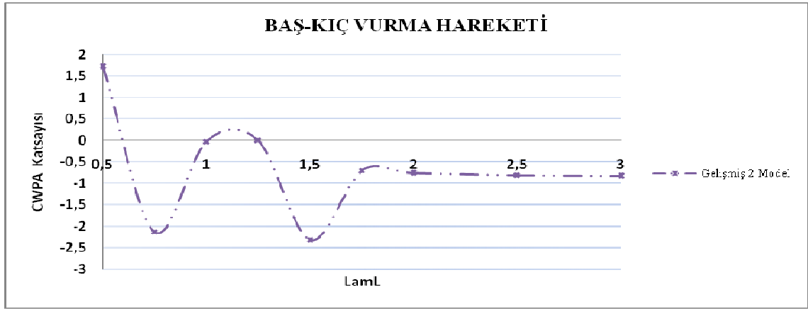
Şekil 9.24 Regresyon modelleri baş-kıç vurma hareketi -CWPA katsayısı karşılaştırma grafiği
