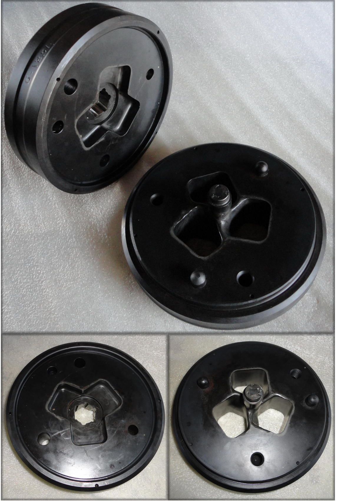
Şekil 9.21 Helisel nervürlü alüminyum boru matris bileşenleri
