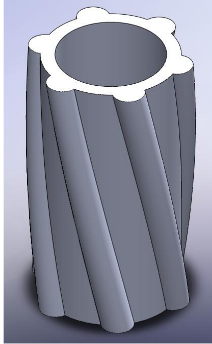
Şekil 9.2 Helisel nervürlü alüminyum borunun bilgisayar destekli modeli
