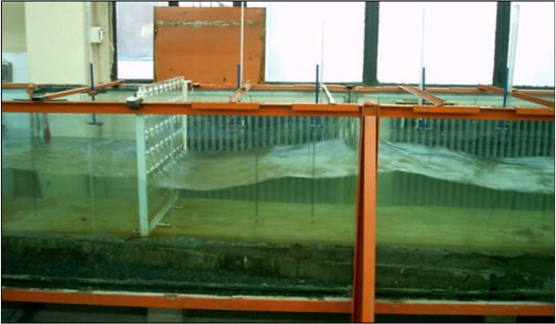
Şekil 4.11 %26 poroziteli duvarın kullanıldığı deneyden bir görünüm
