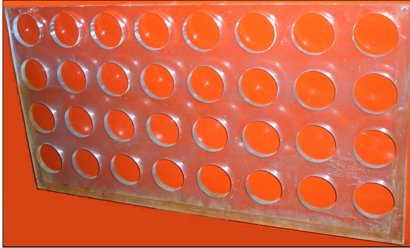
Şekil 4.5 %40 poroziteli perfore duvar modeli
