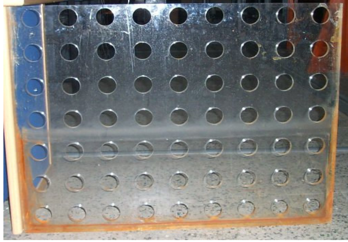
Şekil 4.4 %26 poroziteli perfore duvar modeli
