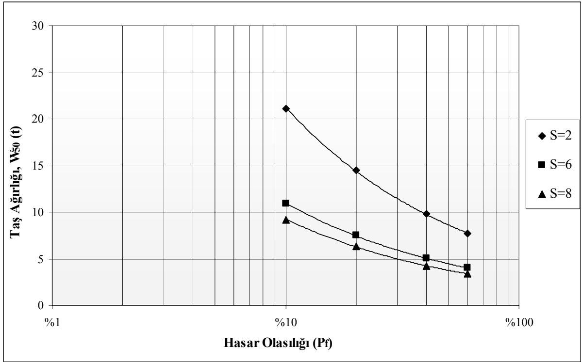
Şekil 4.18 C-C, L-L kesitleri için hasar olasılıklarına bağlı taş ağırlıkları ( \cot \alpha = 2.5 )
