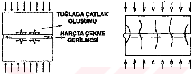
Şekil 6.3 Harç ve blokta ezilmenin oluşumu (Lourenço, 1994)
