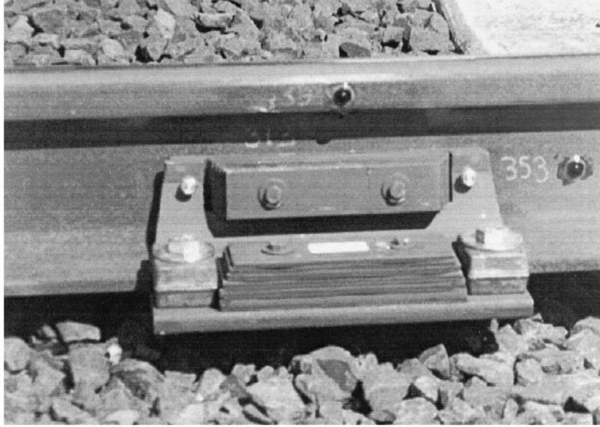
Şekil 3.6 115 lb/yd RE Ray'a takılmış sönümleme aparatı (Manning, 1985).
