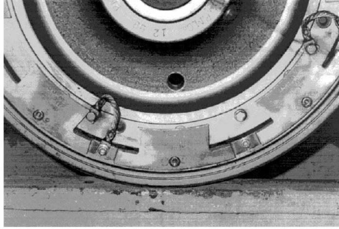
Şekil 3.4 VSG Titreşim sönümleyici takılmış NJT Bochum 54 elastik ray (Manning, 1985).
