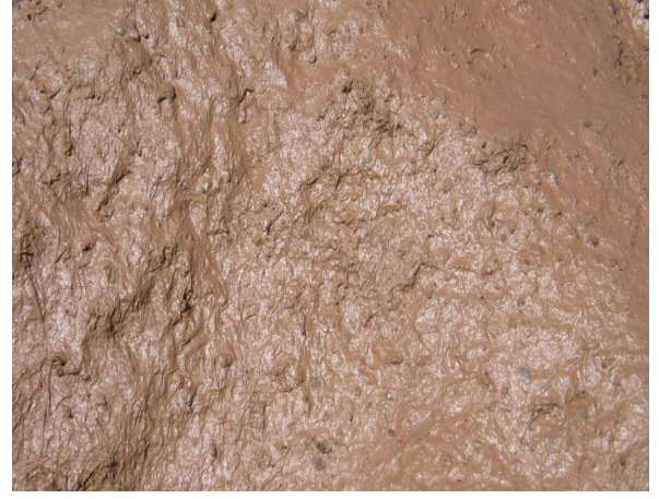
Şekil 3.3. Killerin suya doygun haldeki görüntüsü (Washington State Üniversitesi )
