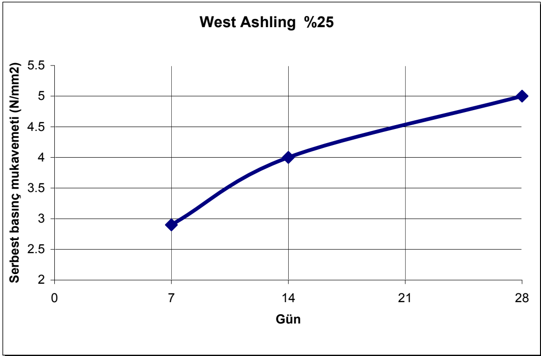
Şekil 6.32 %25 çimento katkılı West Ashling kilinin 7, 14 ve 28. günlerdeki serbest basınç mukavemeti değerlerinin değişimi
