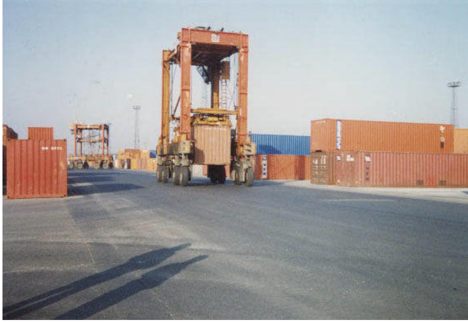
Şekil 4.4 Antwerp (Belçika) limanından örnek Straddle Carrier (SC) (Henesey, 2004)
