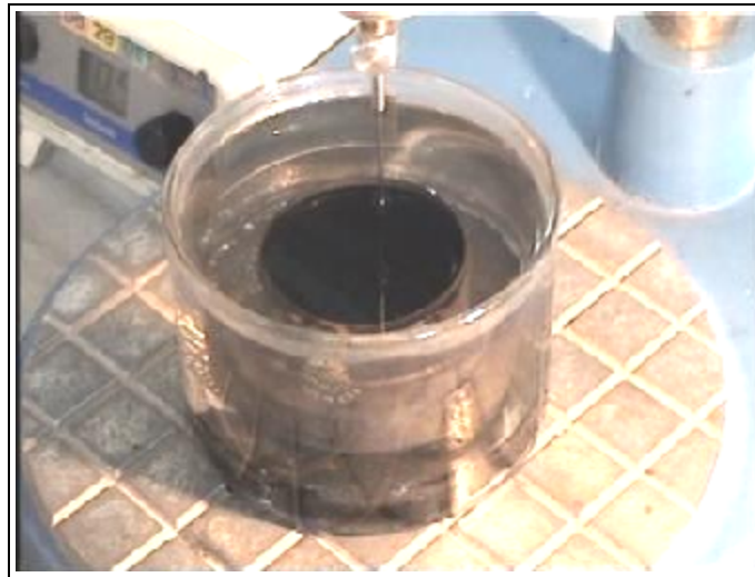
Şekil 3.11 Penetrasyon deney düzeneği (Özen, 2005)
