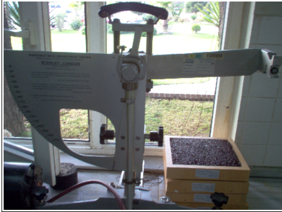
Sekil 3.6 Kayma direnci ölçme cihazı
