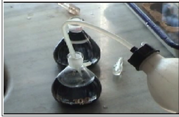
Şekil 3.19 Bağlayıcı özgül ağırlığının piknometre ile tespiti
