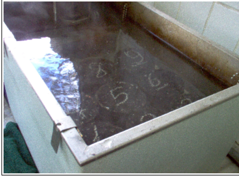
Şekil 7.7 Marshall numunelerinin su banyosunda koşullandırılması
