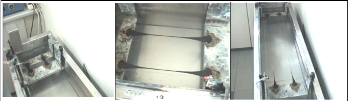
Şekil 3.13 Düktilite deney düzeneği ve deneyin uygulanması (Özen, 2005).
