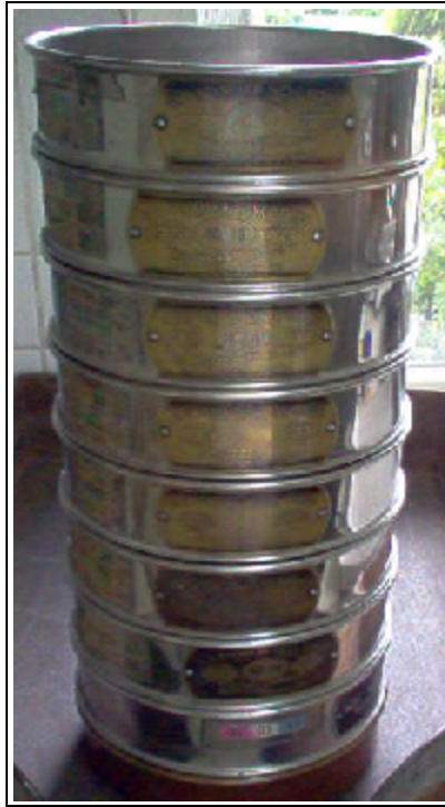
Şekil 3.3 Elek Analizi deneyi için kullanılan standart elek serisi
