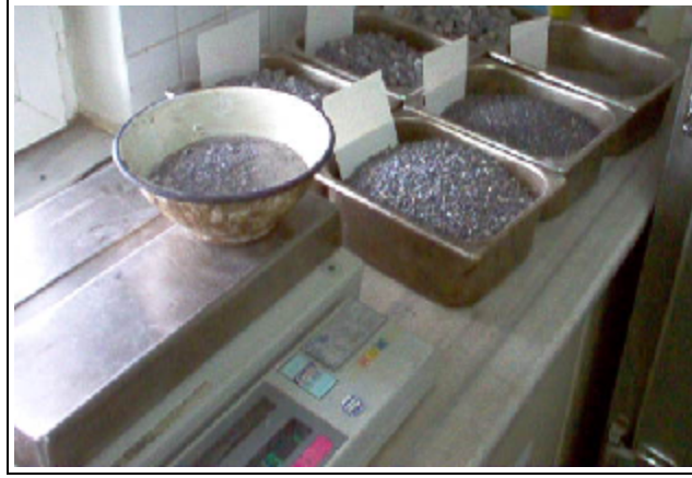
Şekil 7.1 Marshall briketleri için hazırlanan 1150 gramlık agreg a karışım numuneleri
