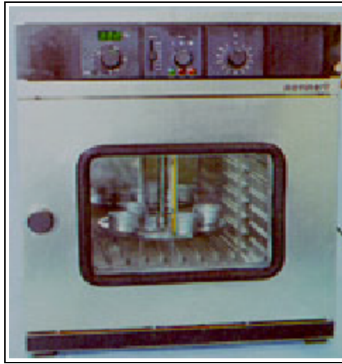
Şekil 3.18 İnce film halinde ısıtma deney aleti
