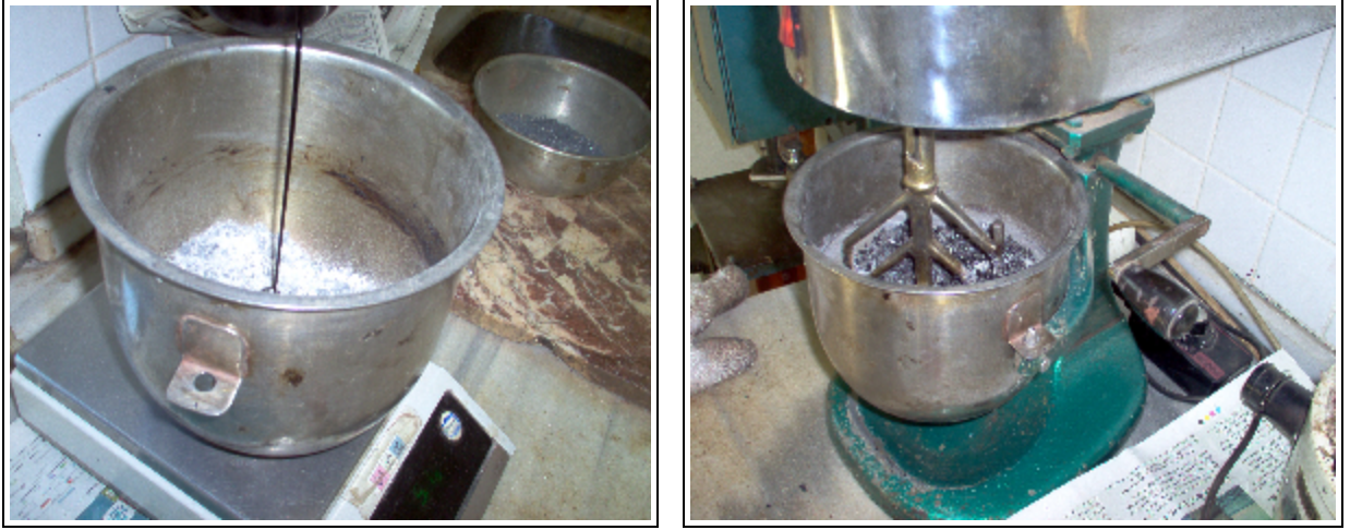
Şekil 7.2 Değişik kireç yüzdelere göre karışımların hazırlanması
