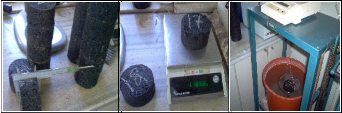
Şekil 7.5 Briketlerin yükseklik ölçümü, havada ve suda tartımları
