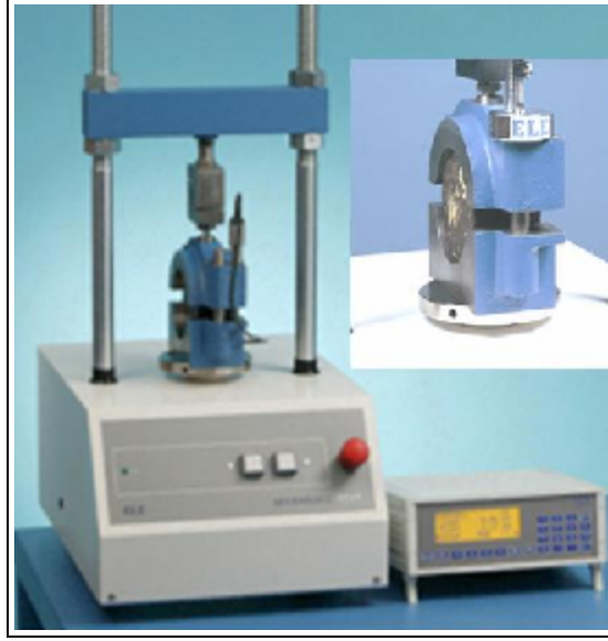
Şekil 7.6 Marshall yükleme cihazı
