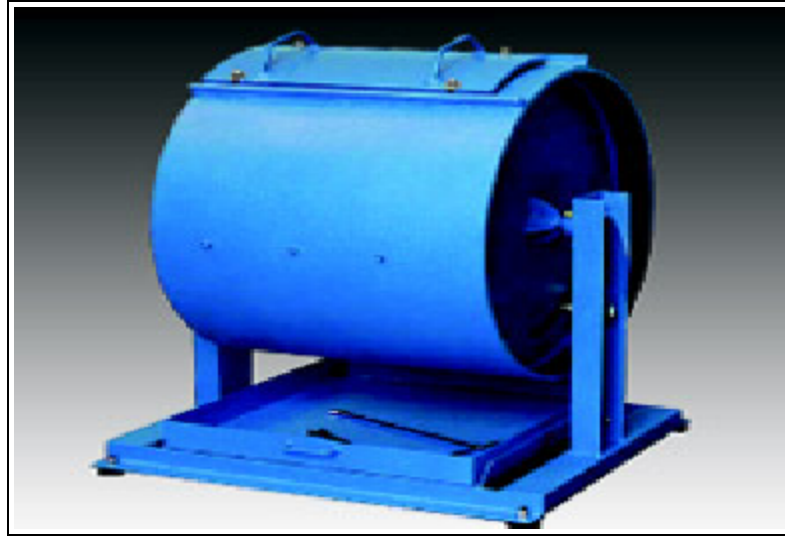
Şekil 3.4 Los Angeles aşındırma makinesi
