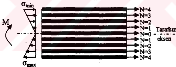
Şekil 3.8 Eşit P yüklerine maruz basit kirişteki izokromat mertebeleri.
