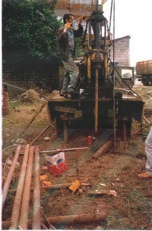
Şekil 3.3 DMT'yi zemin içine itmek için kullanılan araç
