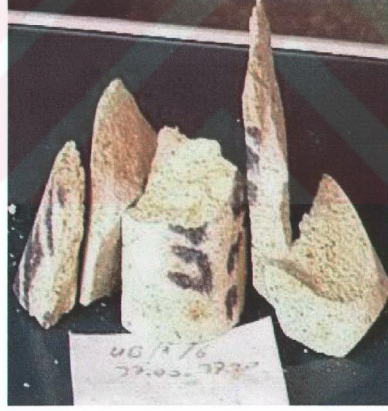
Fotograf 3.6 Uluburun Tüneli girişin kesiminde yapılan sondajların değişik seviyelerinden alınan Üç eksenli basınç dayanım deney karotları ( deney sonrası )
