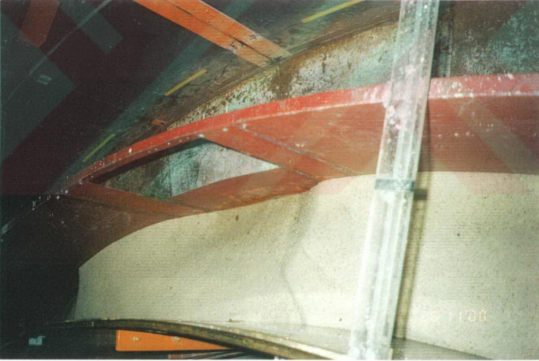
Şekil 4.15.b Büyük mansap hızlarında oluşan taban profili
