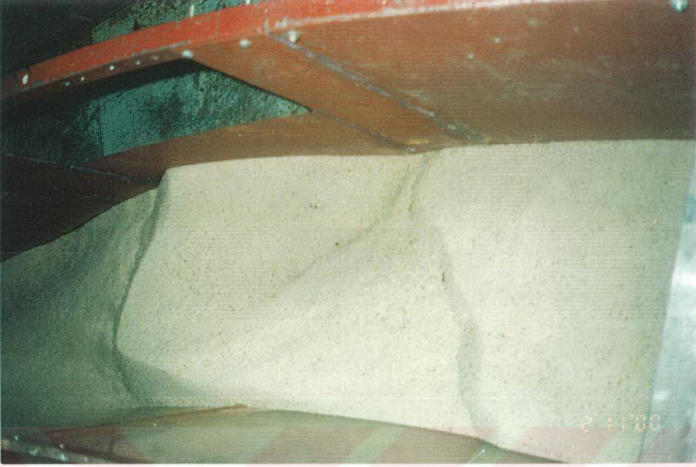
Şekil 4.15.a Düşük mansap hızlarında oluşan taban profili
