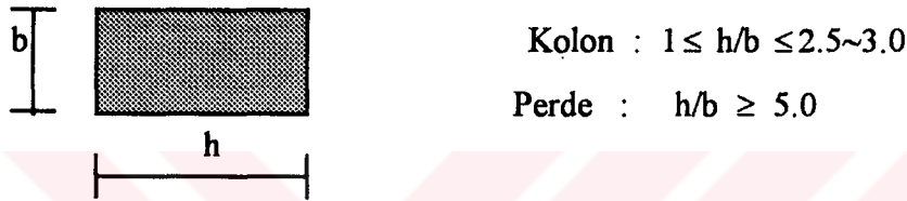
Şekil 1.1. Perde ve kolon tanımı
