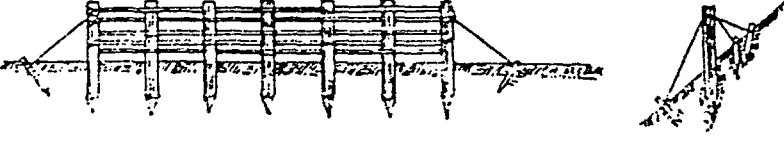
Şekil.17 : Çığlara karşı bir örme çit (Kaynak No:1)
