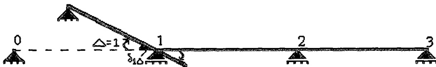
Şekil 2.3.8 : Sürekli kirişte tesir çizgisi istenilen ara mesnete Virtüel deplasman uygulanmış hali
