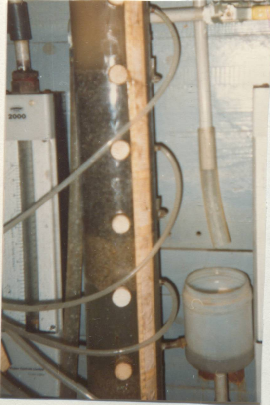
7.3.4. Perlit İle Teşkil Edilmiş Tabakalı Filtre İle, Kum İle Teşkil Edilmiş Filtrelerin Geri Yıkanması.
