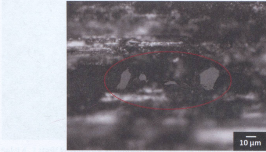
Şekil 4. 5 Hafif koşullarda aşınmış hacimce %15 B 4 C takviyeli kompozit yüzeyinde B 4 C çıkıntılarının optik mikroskop görüntüleri [6,15]
