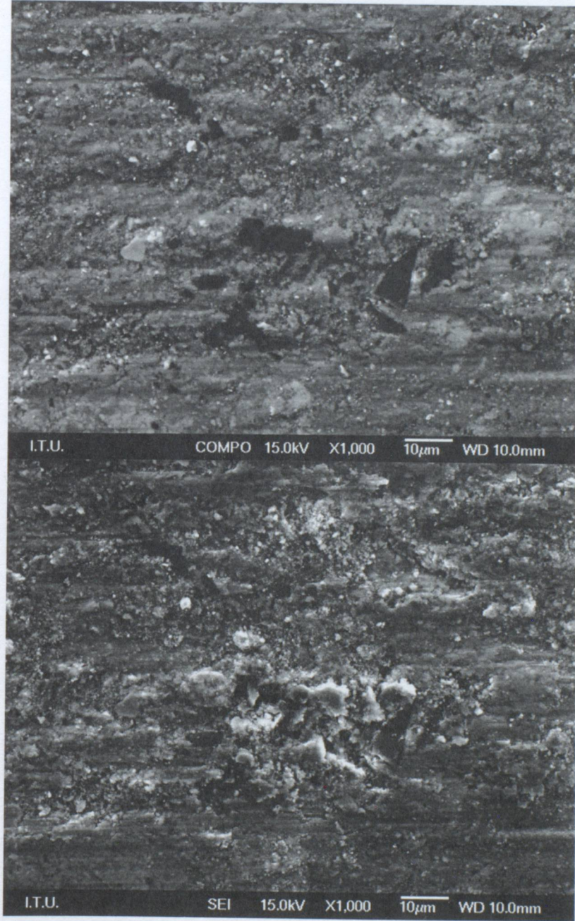
Şekil 6. 17 2 numaralı ağırlıkça %20 takviye B 4 C partikül oranına sahip kompozit numunelere 5 cm/s kayma hızında 5 N yük altında 400 m mesafede yapılmış olan aşınma test grubundan alınmış FEG-SEM görüntüleri
