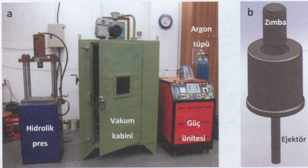
Şekil 5. 4 a) Vakum kabini güç ünitesi ve hidrolik presin görüntüsü b) kokil kalıbın görüntüsü
