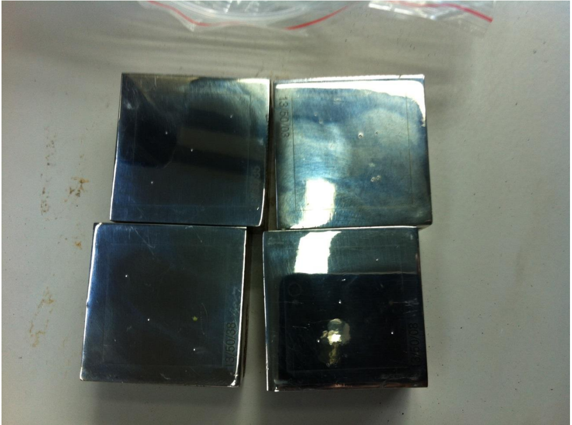
Şekil 3.10 Kararlılık testlerinde kullanılan Rockwell C sertlik numuneleri.
