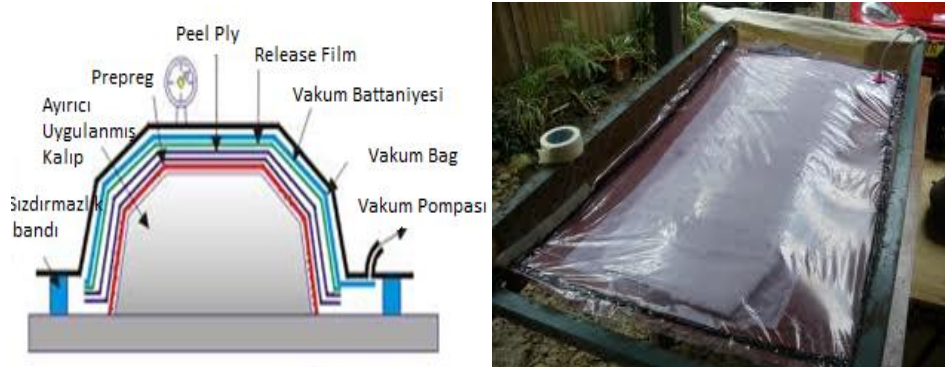
Şekil 5. 5 a) Vakum bag yönteminin şematik gösterimi. b) vakum bag uygulanmış el yatırması prosesi.
