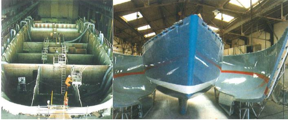
Şekil 5. 3 El yatırması yöntemi üretilmekte olan tekne örnekleri.
