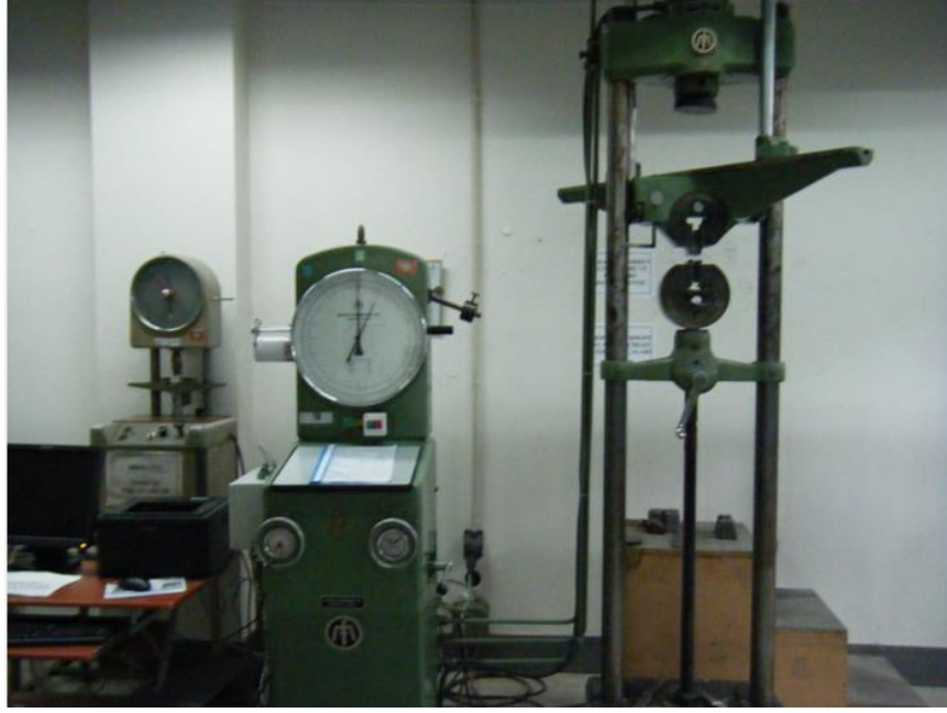
Şekil 6. 22 100 kN kapasiteli, bilgisayar kontrollü Mohr Federhaff marka çekme cihazı.
