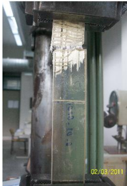
Şekil 7. 2 Çekme yükü altındaki sürekli fiber takviyeli kompozit numune.
