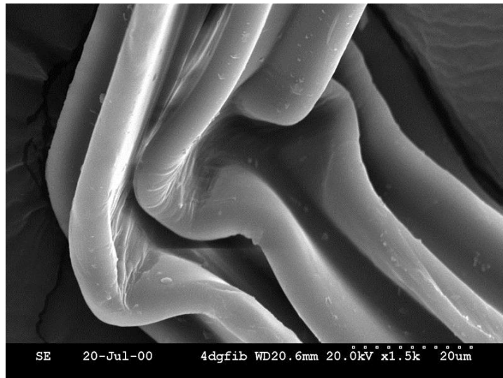
Şekil 3. 2 Polyester malzemenin SEM görüntüsü [41].
