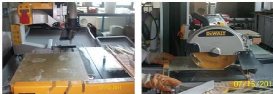
Şekil 6. 19 Numunelerin kesilerek hazırlanması.
