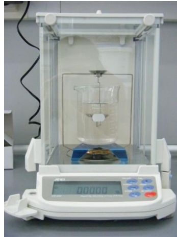
Şekil 6. 27 Hassas terazi ve yoğunluk ölçme aparatı.
