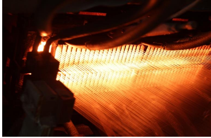
Şekil 3. 6 Fiber çekimi görüntüsü [50].
