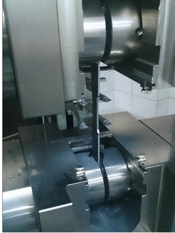
Şekil 3. 20 Çekme cihazında teste tabi tutulan numune
