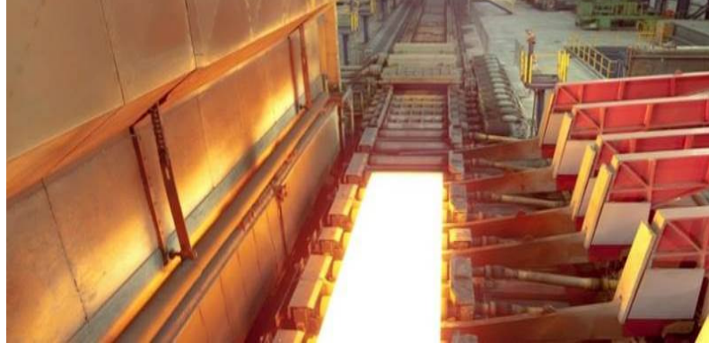
Şekil 3. 7 Fırından alınan slabın hatta verilmesi
