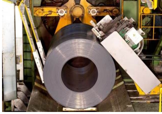
Şekil 3. 18 Çemberleme makinesindeki bobin
