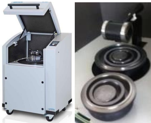
Şekil 4.2 Öğütücü ve öğütme halkaları
