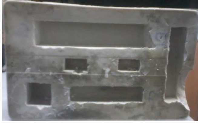
Şekil 4.7 Dökümün yapıldığı kauçuk kalıp
