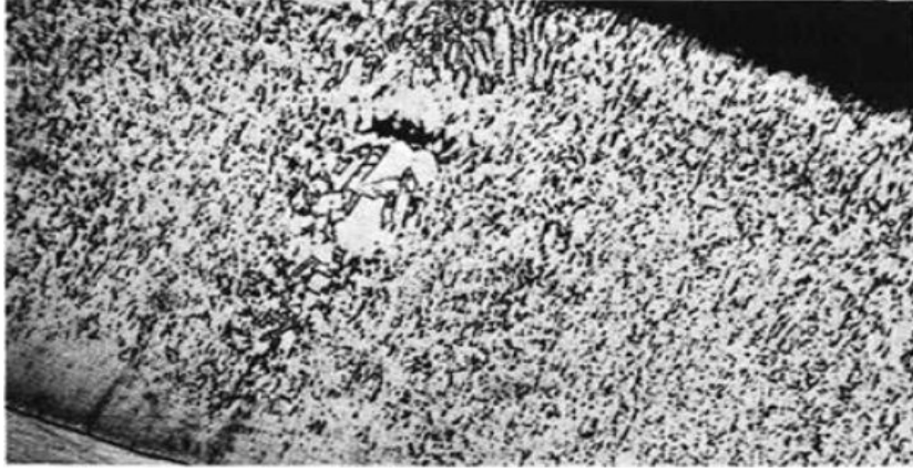
Şekil 2-2. Geleneksek yöntemle galvanizlenmiş % 0,08 Si içeren çeliğin mikroskop altında görüntüsü
