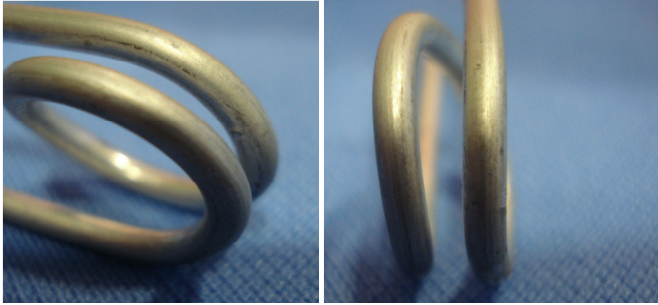
Şekil 6.1-11 Zn-Ni banyosuna daldırılan çelik telin yapışma testi sonuçları
