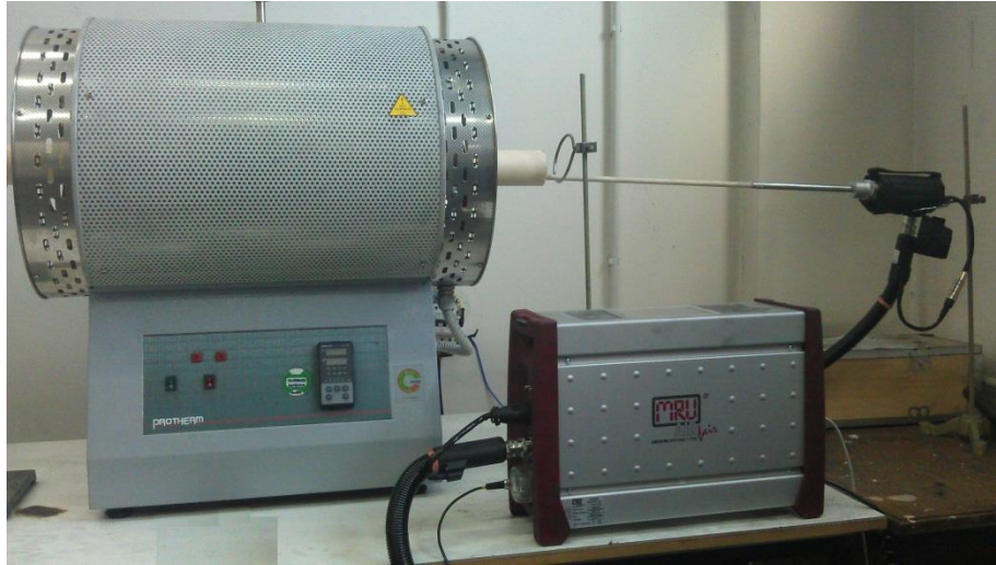
Şekil 5.2 Redüksiyon için kullanılan yatay tüp fırın ve MRU marka gaz analiz cihazı
