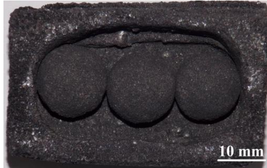
Şekil 5.5 Grafit kayıkçık içerisine yerleştirilmiş pelet numuneleri
