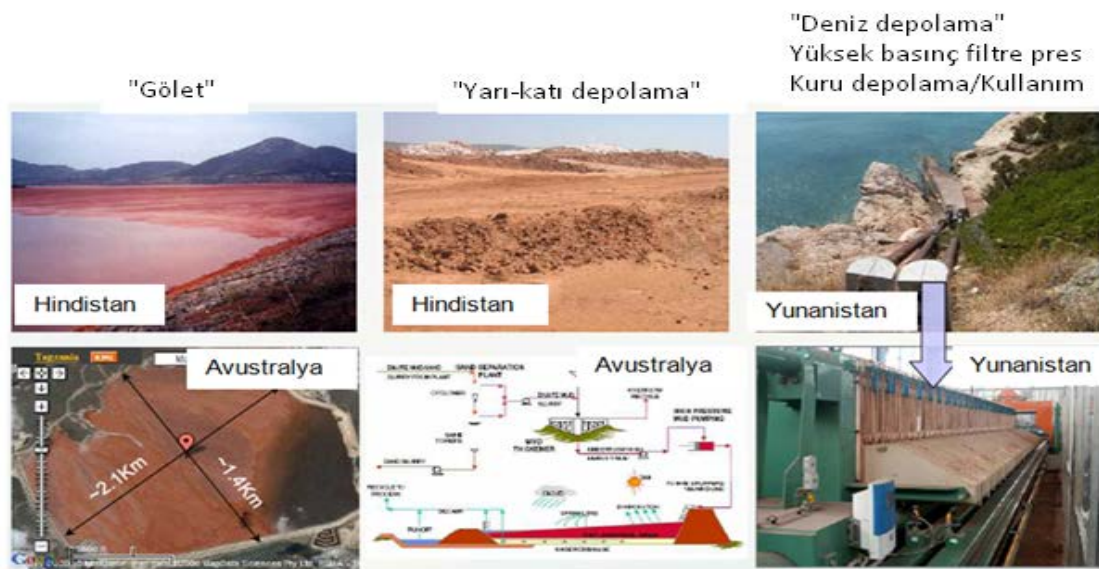
(a) Kırmızı çamurun farklı yöntemlerle depolanma şekilleri
