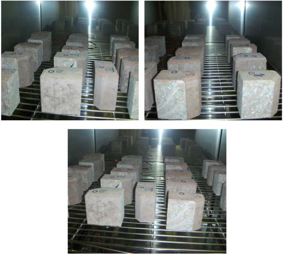
Şekil A. 14 Parke taşlarının iklimlendirme kabineye yerleştirilmesi
