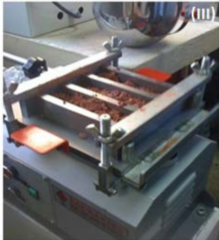
Şekil A. 8 Harç numunelerinin hazırlandığı kalıp düzeneği
