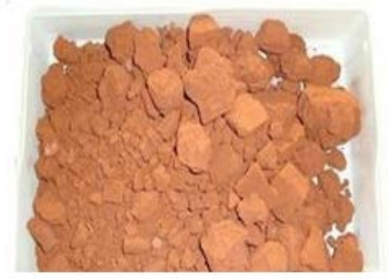
Şekil A. 5 Ham kırmızı çamurun kurutma prosesi öncesi ve sonrası görüntüleri
