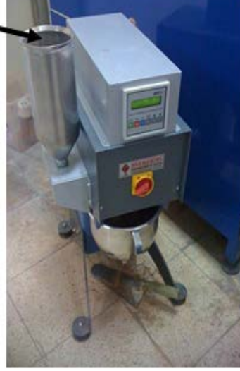
Şekil A. 7 Harç karışımlarının karıştırıldığı karıştırıcı
