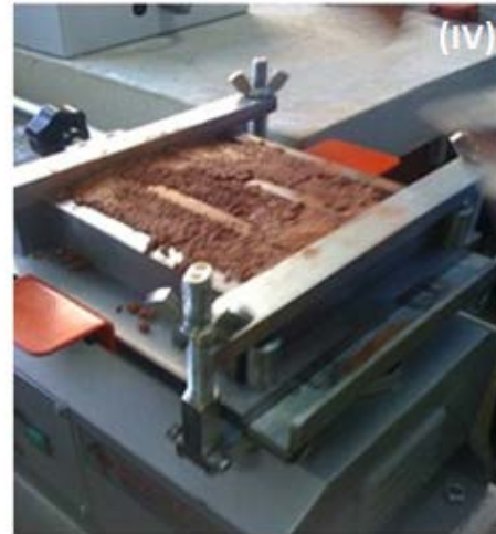
Şekil A. 8 Harç numunelerinin hazırlandığı kalıp düzeneği
