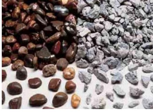
(a) Çakıl (sol) kırma taş (sağ) doğal agregalar
