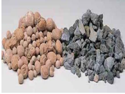
(b) Genleştirilmiş kil (sol), cüruf (sağ) yapay agregalar
